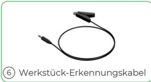
Stecken Sie das Steckerende in den Anschluss für das Werkstück-Erkennungskabel am Hauptgerät. Befestigen Sie die Klemme am anderen Ende am zu bearbeitenden Werkstück oder an einem leitenden Arbeitstisch, der mit dem Werkstück verbunden ist.
