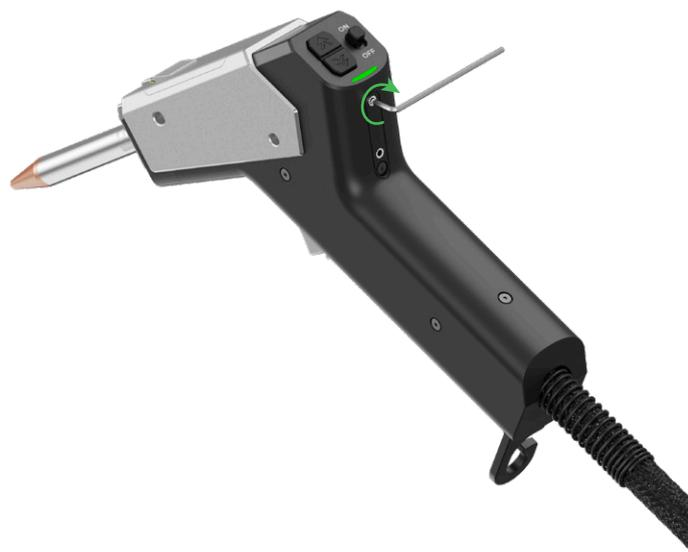
(3) Führen Sie den Inbusschlüssel in Loch 2 ein und drehen Sie die Schraube langsam gegen den Uhrzeigersinn, während Sie das aus der Düse austretende Licht beobachten. Sobald ein klarer roter Punkt erscheint, stoppen Sie das Drehen.
