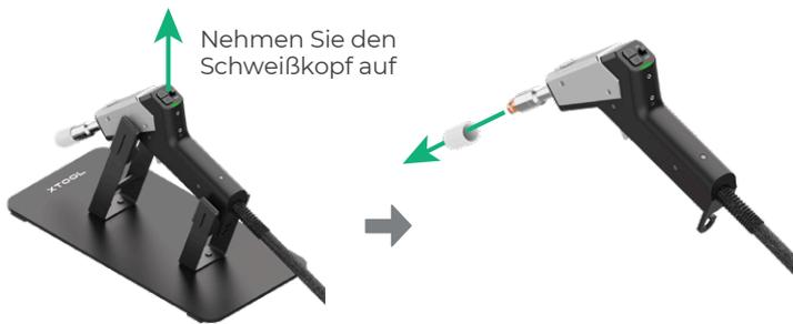
(2) Öffnen Sie den Verschluss am Drahtvorschubrohr.
